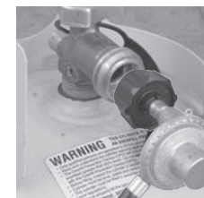
(C) Maintenir l'écrou de raccordement et le détendeur, tel qu'indiqué, pour assurer un bon raccordement au robinet de la bouteille de GPL
